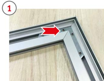
Schrauben Sie die Profile und die Eckprofile mithilfe eines geeigneten Inbusschlüssels zusammen. Achten Sie darauf, dass die Ecken genau auf Gehrung verschraubt werden.
