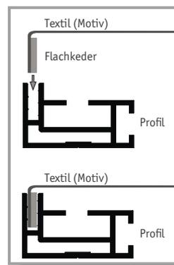
An einer Ecke beginnend drehen sie den angenhten Flachkeder mit beiden Hnden um 90° nach innen und fgen diesen in die Nut des Rahmens ein. So verfahren Sie zunchst an allen vier Ecken danach streichen Sie mit dem Daumen entlang der Lngsseiten.
