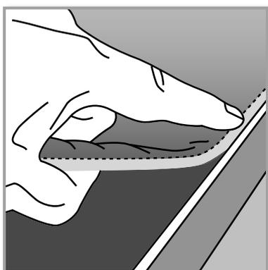
Ein Austausch der Bespannung ist jederzeit mglich. Mit Hilfe des angenhten Fhnhens lsst sich der Stoff problemlos aus dem Rahmen entnehmen.
