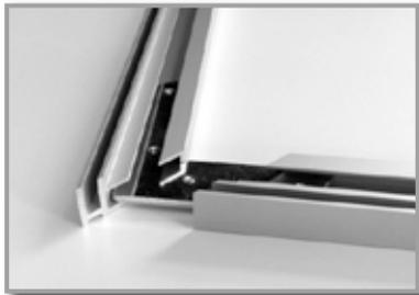
Die Rahmenprofile werden mittels Eckverbindern zusammengesetzt. Eine Fixierung erfolgt durch das Festziehen der Madenschrauben mit dem Imbuss-Schlssel.
